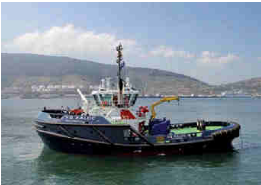
► El primero de una serie de diez gemelos, con casi 32 metros de eslora y 79,60 toneladas de tiro a punto fijo.
