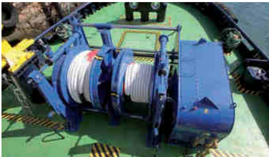
► Cubierta de popa despejada y maquinilla de remolque de Ibercisa. A la izquierda, el soporte de la grúa de trabajo.
