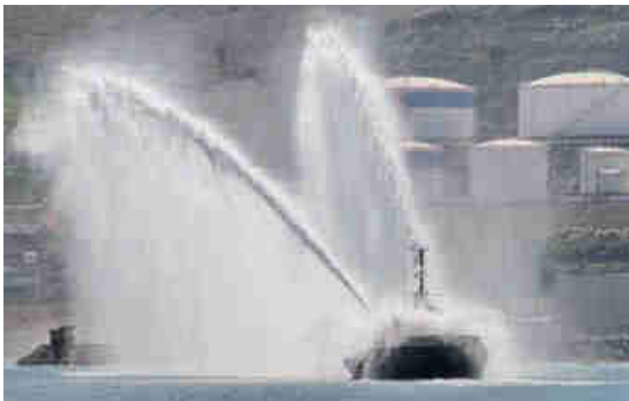
► Los sistemas FIFI del “VB Xaloc” son puestos a prueba.
