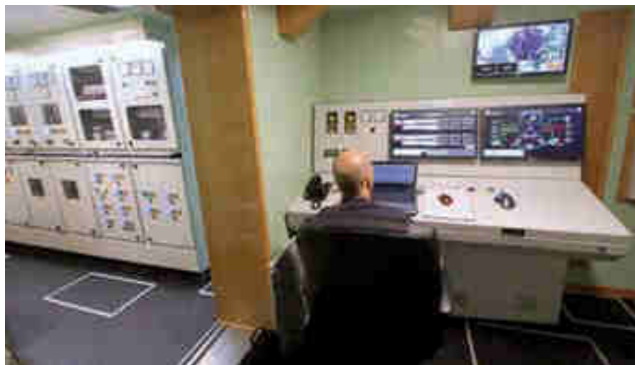
► Cuadros de control integrado de la máquina y los elementos del buque, instalados por Itxasmarine.
